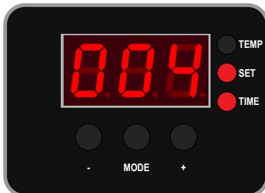
La minuterie compte à rebours et vous signale de manière audible de soulever le plateau supérieur en position HAUT lorsque le cycle de presse est terminé. Le temps sera automatiquement réinitialisé et vous êtes prêt à continuer avec la prochaine application.
