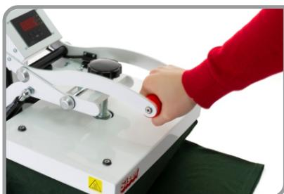
Abaissez et verrouillez le plateau supérieur chauffant en position de presse. Le processus de chronométrage automatique démarre.
