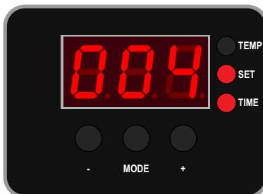
El cronómetro hará el conteo y se escuchará una señal para indicarle que puede levantar la plancha cuando el ciclo de estampado se haya completado. El tiempo se re-programará automáticamente y usted estará listo para continuar con la siguiente aplicación.
